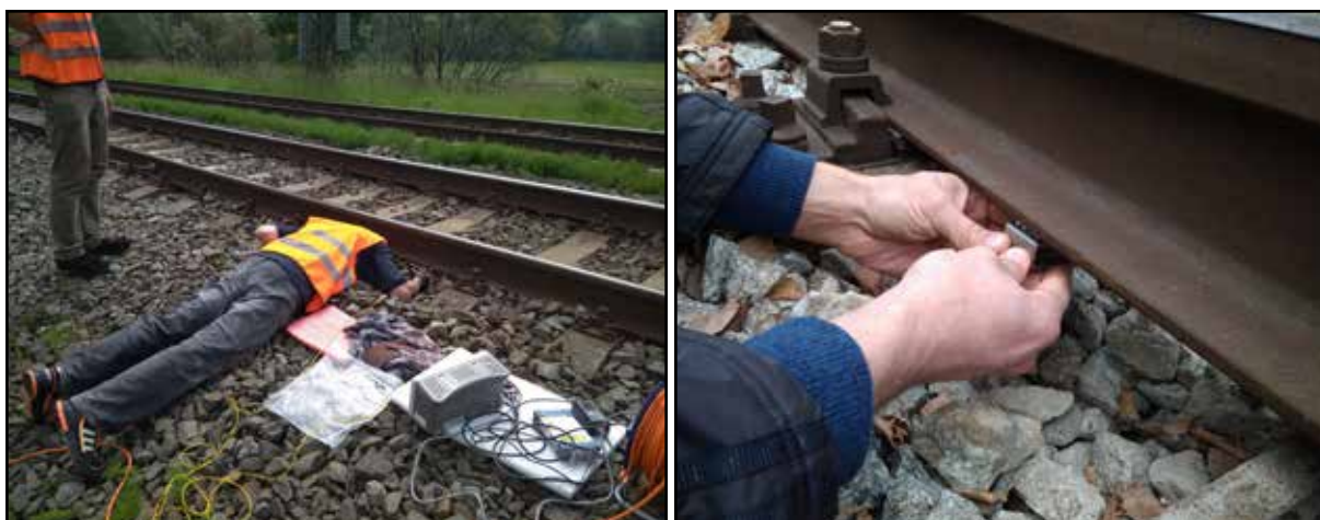
Obr. 3, 4: Výskumník „stráca“ hlavu pri umiestňovaní prototypu zo spodnej časti koľajnice za účelom overenia funkčnosti v reálnych podmienkach.
