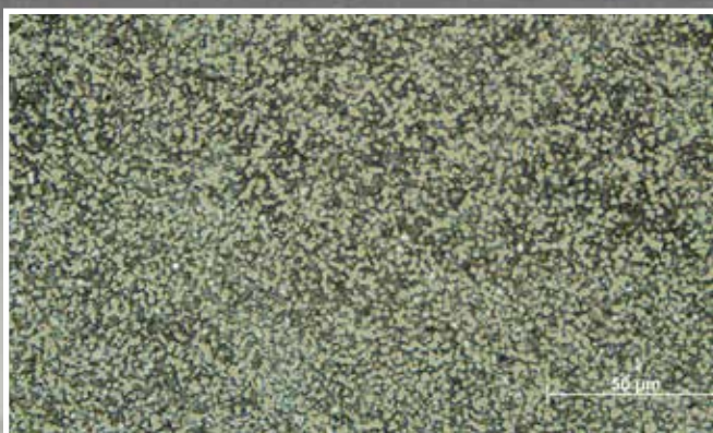
Obr. 4. a) Mikroštruktúrna analýza skúmanej oblasti testovaného novovyvíjaného materiálu M398 pro- stredníctvom zabudovaného mikroskopu ako súčasť konfigurácie zariadenia Hysitron TI 950. Triboindenter
