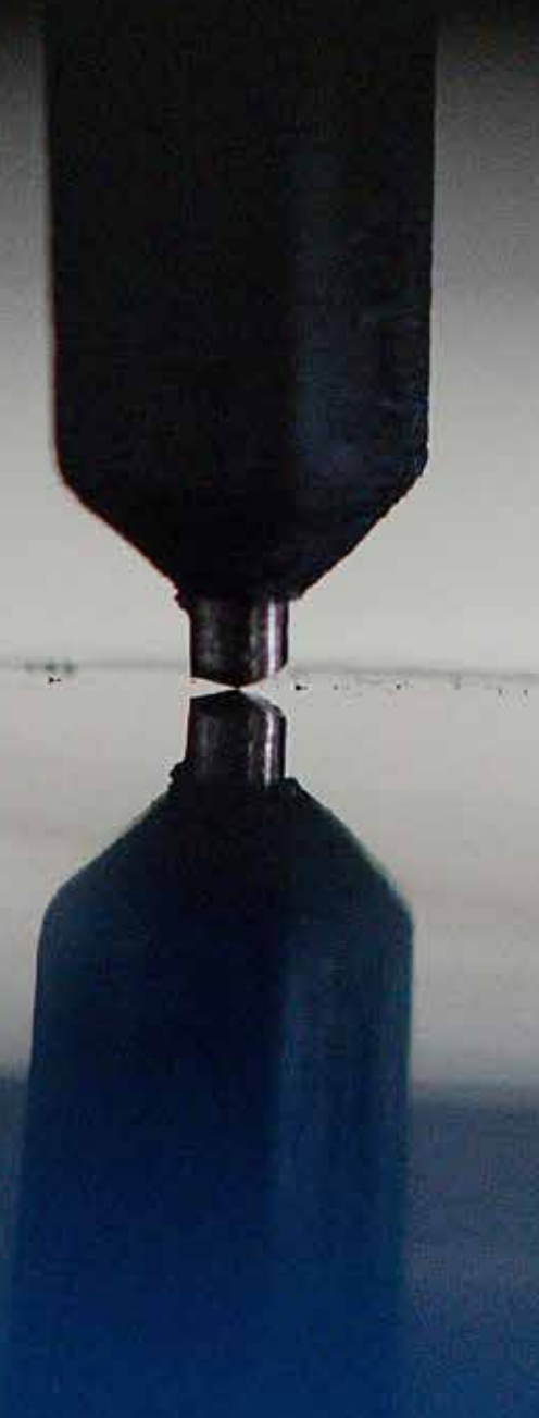
Obr. 4. a) Mikroštruktúrna analýza skúmanej oblasti testovaného novovyvíjaného materiálu M398 pro- stredníctvom zabudovaného mikroskopu ako súčasť konfigurácie zariadenia Hysitron TI 950. Triboindenter
